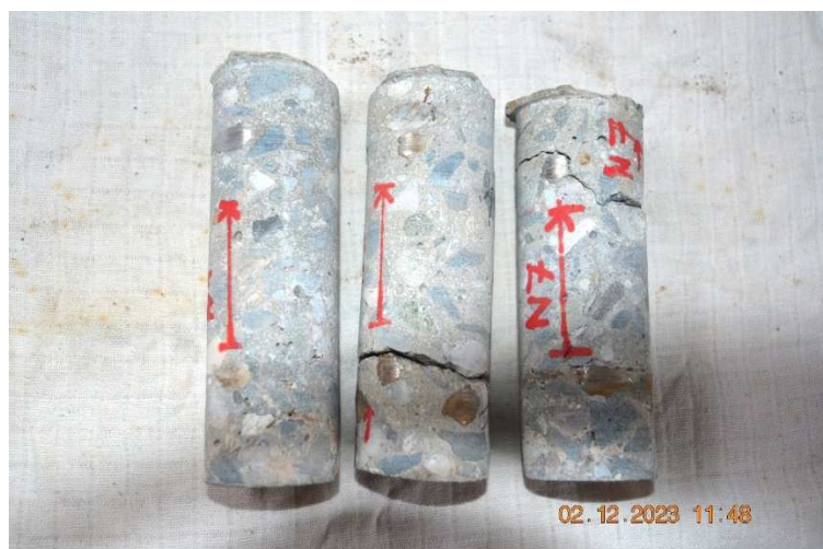
Nepoškozená krycí vrstva měkké výztuže v dolních přírubách nosníků – vývrtý DN = 50 mm.
