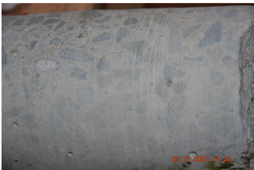
Detail vývrtu PI 2 do dílců dříku pilíře blíže k pravému břehu dolů pod hladinu obsahuje výztuž zcela sporadicky. Výztuž nekoroduje.
