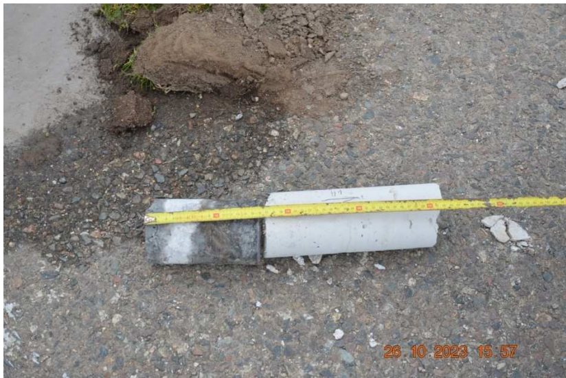
Vývrt H1 ve středu rozpětí středního pole na návodní straně včetně konstrukce vozovky.
