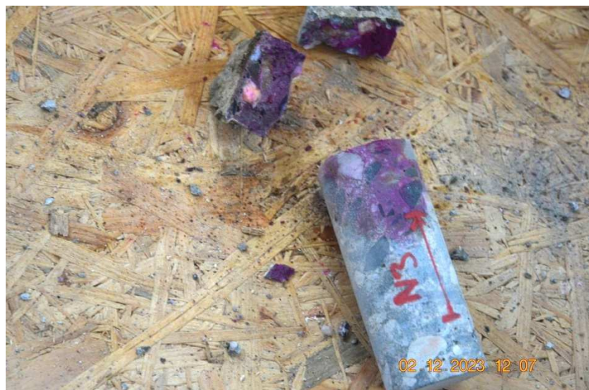
Test fenolftaleinem na dolní přírubě nosníku ze strany dutiny mezi nosníky v 1. poli, dutina byla plná vody.
