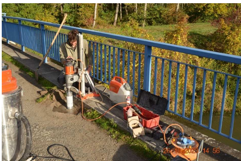
Vývrt H1 ve středu rozpětí středního pole na návodní straně.
