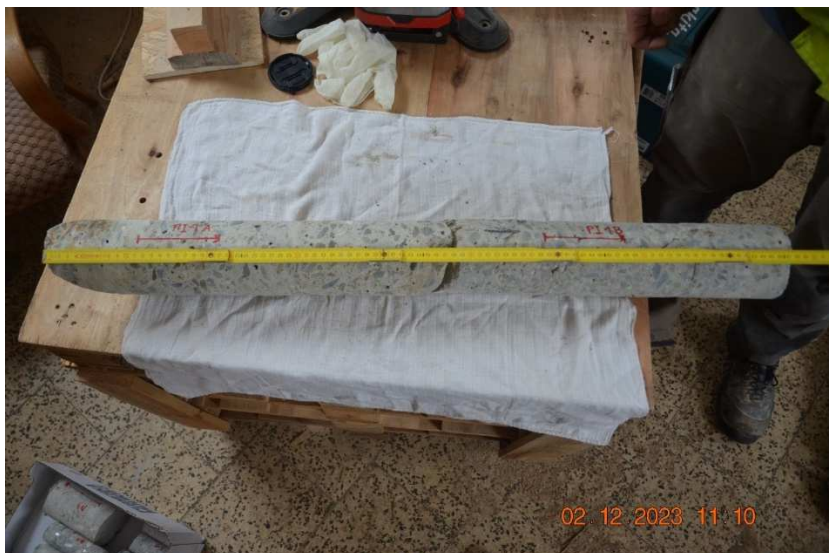
Beton ze šikmého vývrtu PI 1 do dílců dříku pilíře blíže k pravému břehu dolů pod hladinu obsahuje výztuž zcela sporadicky. Výztuž nekoroduje.
