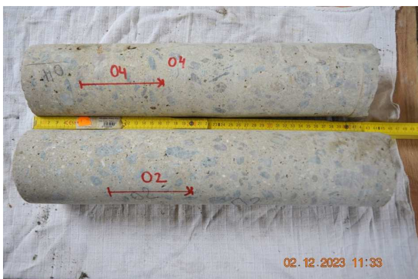
Jádra D = 100 mm z vývrtů O2 a O4 do dřívků krajních opěr z prostého betonu.
