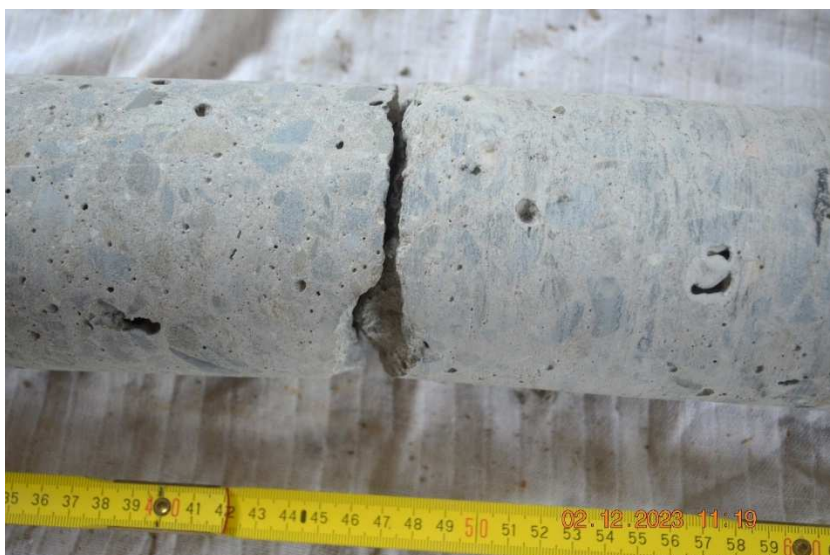
Jádro z vývrtní PI 1, beton dílců pilíře je jen slabě vyztužen, póry do 5 mm.
