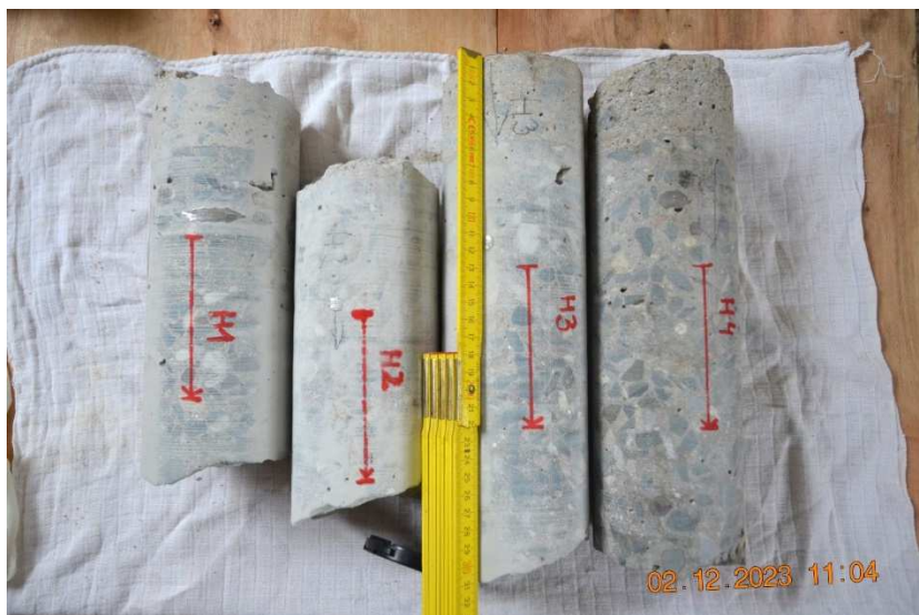
Vývrt H1 až H4 provedené svisle přes vozovku do horních přírub nosníků, na barvě betonu se výrazně odlišuje mazanina spádové vrstvy. Betonářská výztuž je zcela zdravá, bez koroze.
