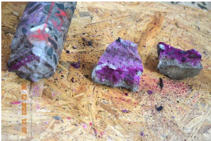
Detail vzorku N7 př fenolftaleinovém testu na rozseknutém jádru na straně z dutiny mezi nosníky (zevnitř).
