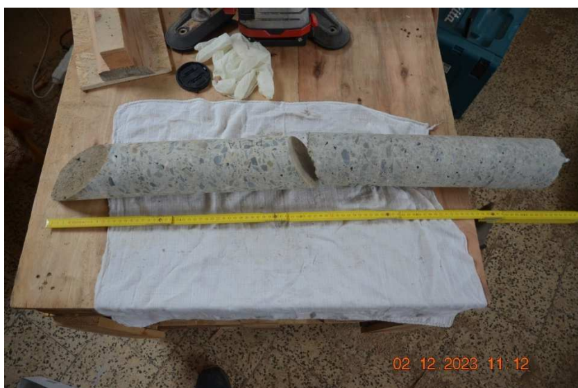
Jádro z vývrtu PI 1, beton dílců pilíře je jen slabě vyztužen, póry do 5 mm.
