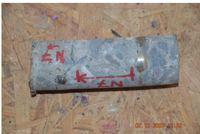
Jádro D = 50 mm z vývrtu do podhledu vzhůru nohama ve 3. poli – do dolní příruby nosníku.
