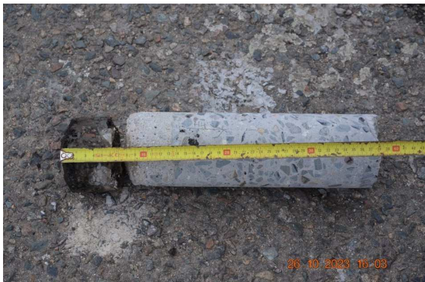
Vývrt H4 ve středu rozpětí 3. pole (blíže k levému břehu) na povodní straně včetně konstrukce vozovky.
