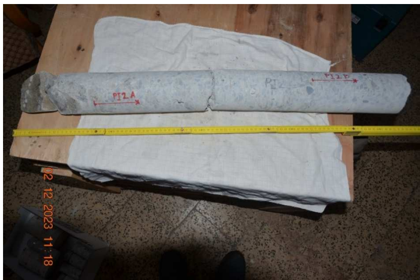
Jádro z vývrtní PI 2, vývrt byl proveden před vodorovnou spárou mezi prefabrikovanými dílci pilíře blíže k pravému břehu, spára je rozvolněná a dílce nejsou spojené.
