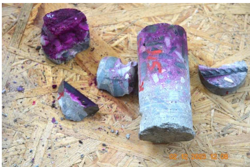
Vzorek N5 po fenolftaleinovém testu do dolní příruby nosníku na povrchu podhledu.
