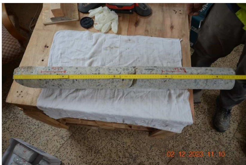
Jádro z vývrtu PI 1, vývrt byl proveden před vodorovnou spáru mezi prefabrikovanými dílci pilíře blíže k levému břehu, spára je rozvolněná a dílce nejsou spojené.
