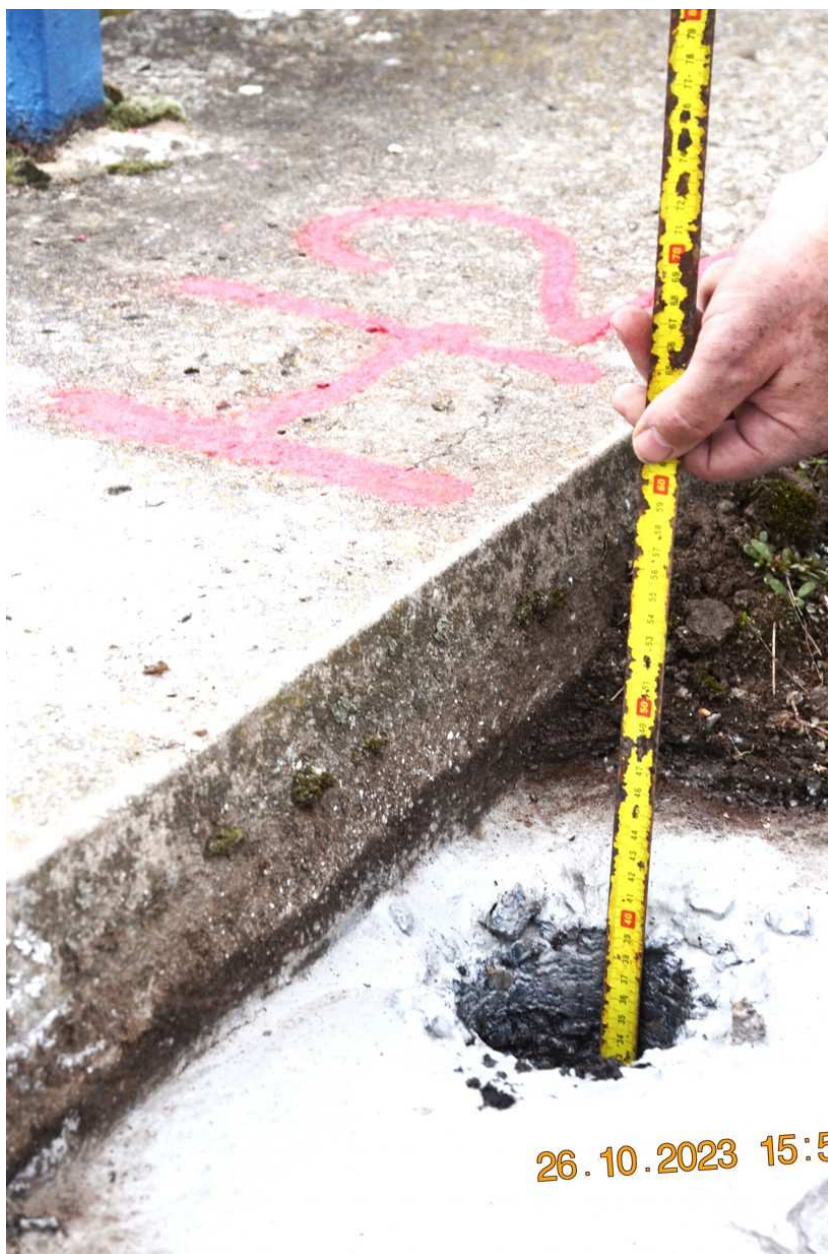
Vývrt H2 ve středu rozpětí středního pole na povodní straně včetně konstrukce vozovky.
