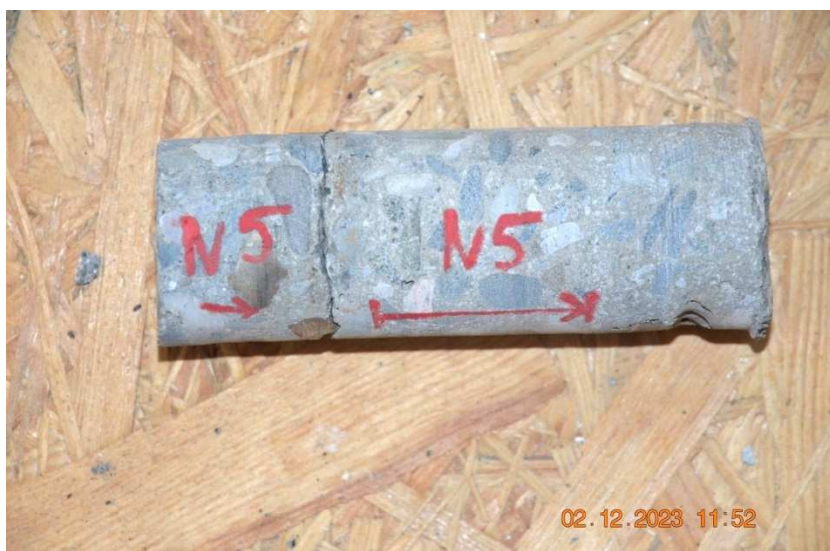
Jádro D = 50 mm z vývrtu do podhledu vzhůru nohama v 1. poli – do dolní příruby nosníku.
