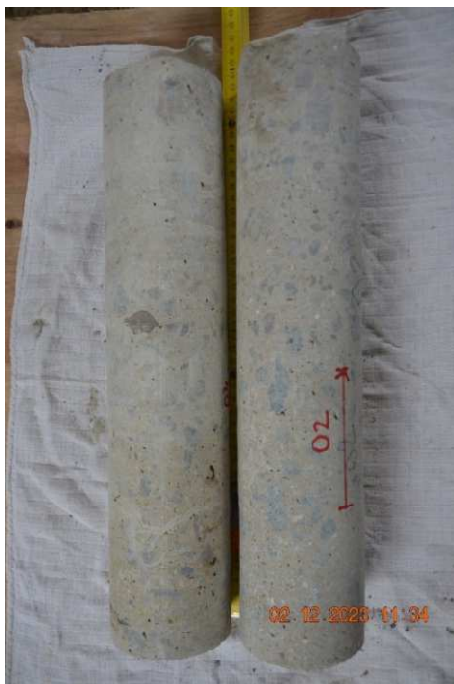
Vývrty O2 a O4 z dříků krajních opěr, jedna vložka výztuže byla zjištěna ve větší hloubce, možná slouží jako kotvení úložného prahu.
