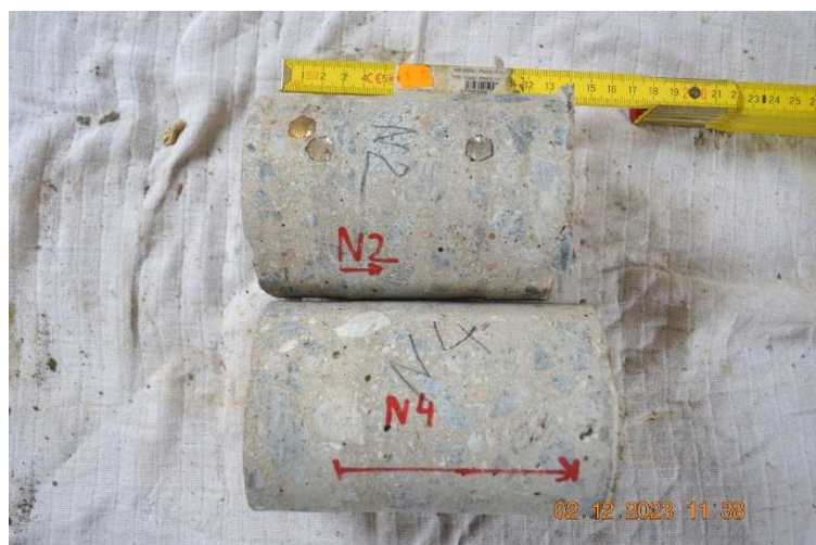
Nepoškozená krycí vrstva měkké výztuže v dolních dobetonávkách mezi nosníky – vývrtý DN = 100 mm.
