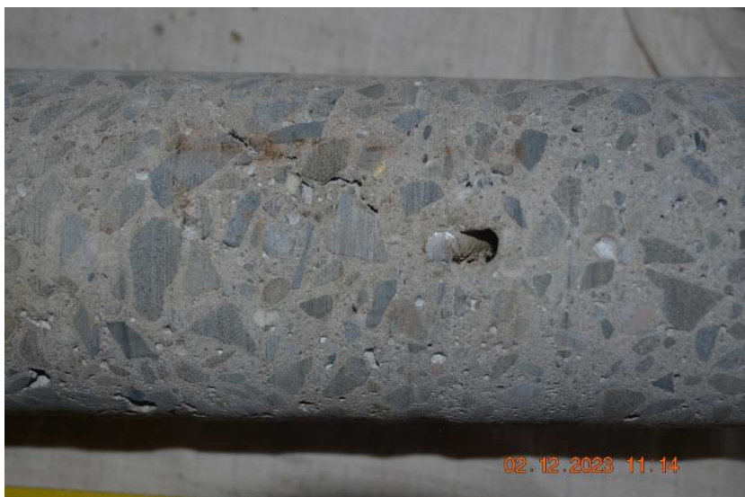
Detail z předchozí fotky s výztuží. Ve vzorku jsou drobné kaverny.
