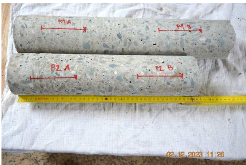
Vodorovné vývrty P1 a P2 do úložných prahů středních pilířů – do návodních dílců. Beton je pórovitý, velikost pórů do 5 mm.
