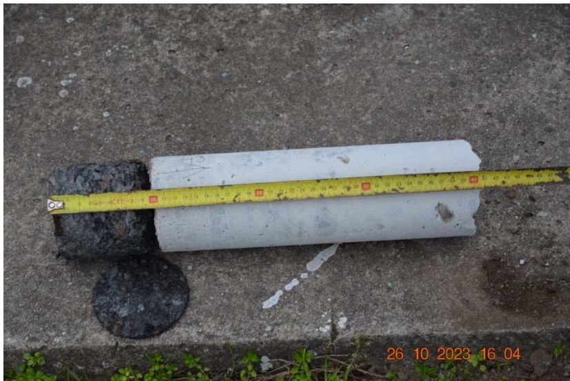
Vývrt H3 ve středu rozpětí 3. pole (blíže k levému břehu) na návodní straně včetně konstrukce vozovky s izolací.
