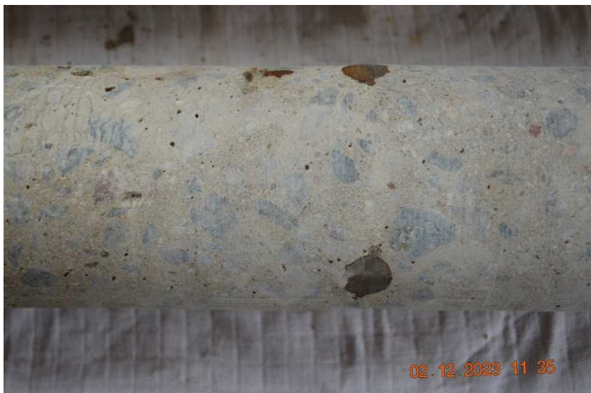
Vývrt O4 z dříku levobřežní opěr, jedna vložka výztuže byla zjištěna ve větší hloubce, možná slouží jako kotvení úložného prahu.
