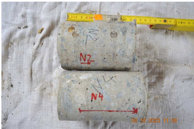
Vývrty D= 100 mm do podhledu vzhůru nohama - do dobetonávky spár mezi nosníky.
