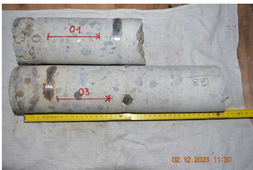
Jádra D = 100 mm z vývrtů O1 a O3 do úložných prahů krajních opěr.
