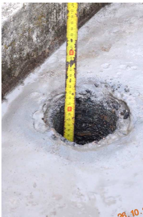
Vývrt H4 ve středu rozpětí 3. pole (blíže k levému břehu) na povodní straně včetně konstrukce vozovky.
