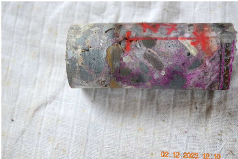
Fenolftaleinový test na vzorku N7 ze strany dutiny mezi nosníky (zevnitř), dutina byla bez vody, suchá.
