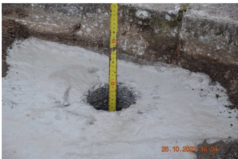
Vývrt H3 ve středu rozpětí 3. pole (blíže k levému břehu) na návodní straně včetně konstrukce vozovky.
