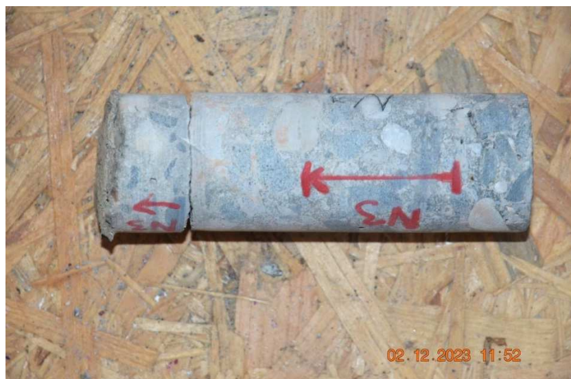
Jádro N3 D = 50 mm z dolní příruby nosníku v1. poli pod dutinou plné vody.
